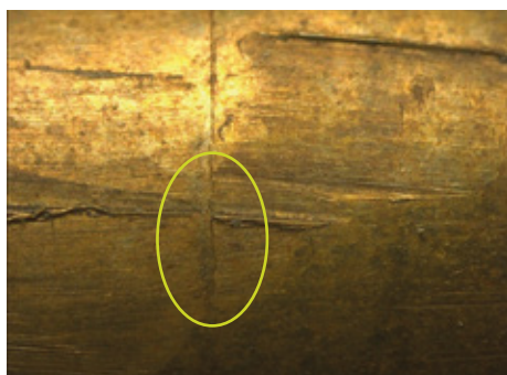
Figura 5. Fisura en proyectil encamisado
